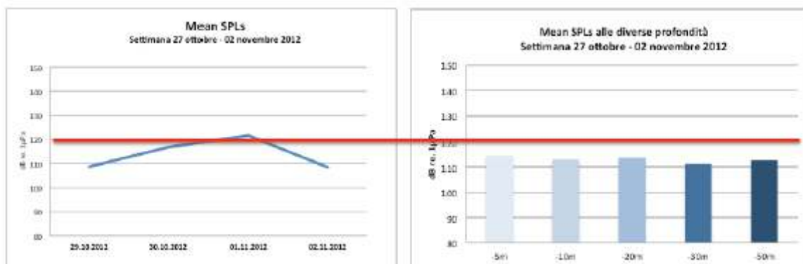
Figura 3. Mean Sound Level: andamento medio dei valori registrati nella settimana (a) e alle diverse profondità (b) (per la zona di esclusione di 1000m dalla nave, la barra rossa rappresenta il valore soglia).
