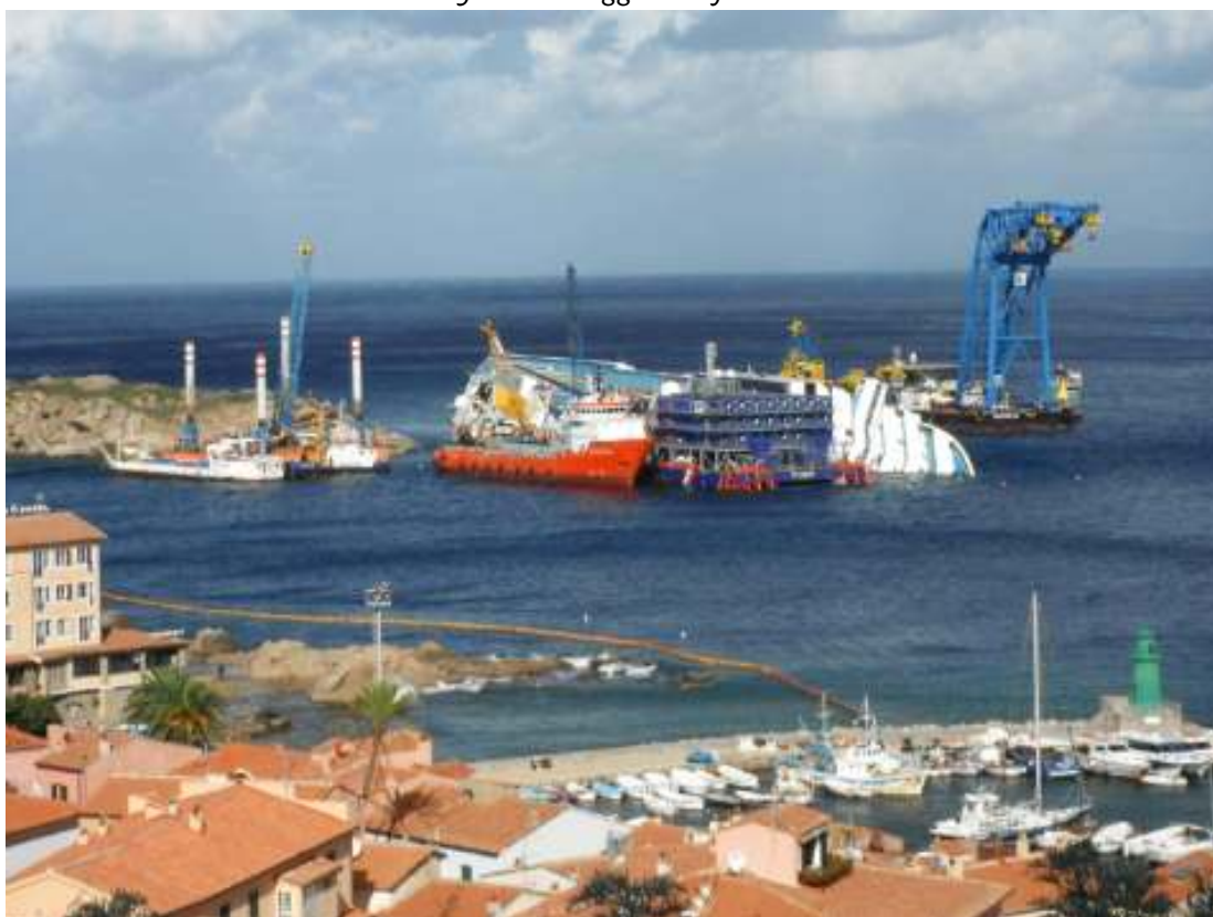
Sopra: Tensionamento cavi di ritenuta su murata sinistra Costa Concordia Sotto: Malaviya 20 ormeggiato a fianco del Pioneer.
