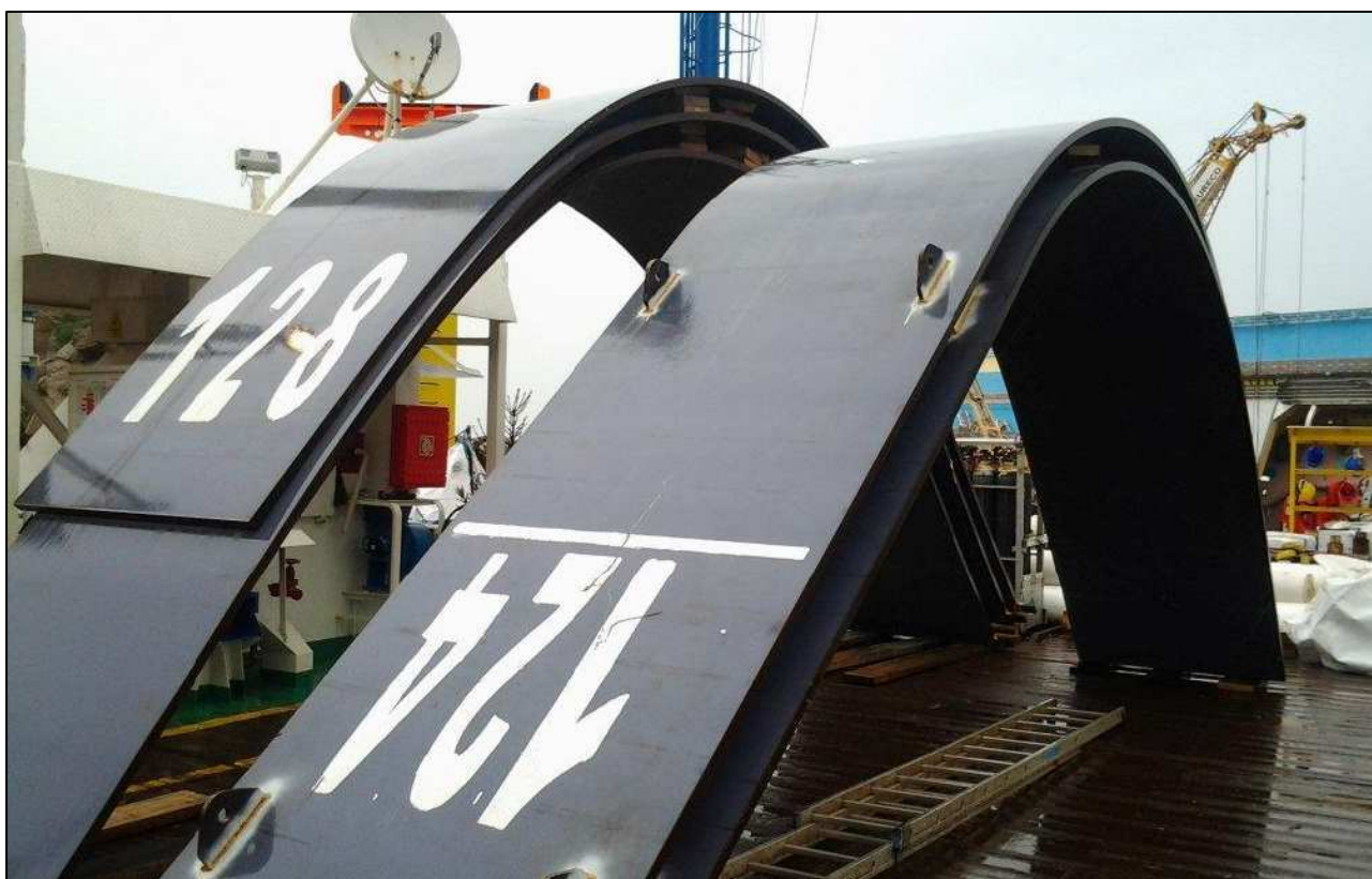
Sopra: Anchor block 11 pronto per la prova di posizionamento sul fondale Sotto: Rinforzi per la carena della Costa Concordia a bordo della Micoperi 61
