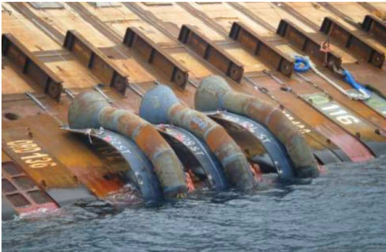
Installazione bilge plates sulla fiancata sinistra della Costa Concordia
