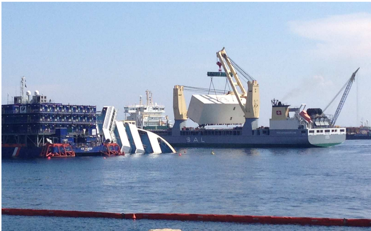
Operazioni di posizionamento Cassone di Spinta P03 sul lato sinistro della Costa Concordia
