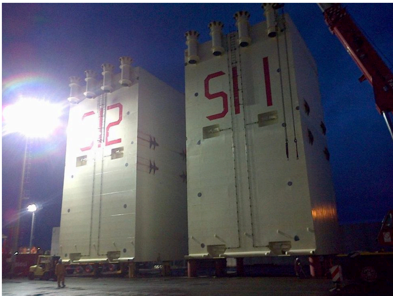
Rotazione cassone di spinta S11 presso il cantiere di Livorno
