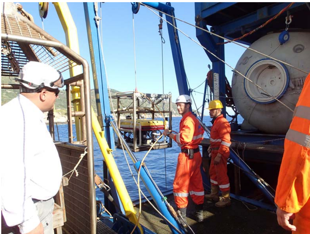
A bordo del Remas si mette in acqua il ROV per effettuare il survey sui debris
