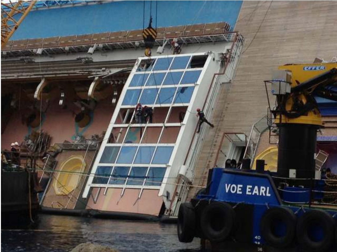
Sopra: rimozione macrodome piscina centrale. Sotto: macrodome sul Navalmare 1
