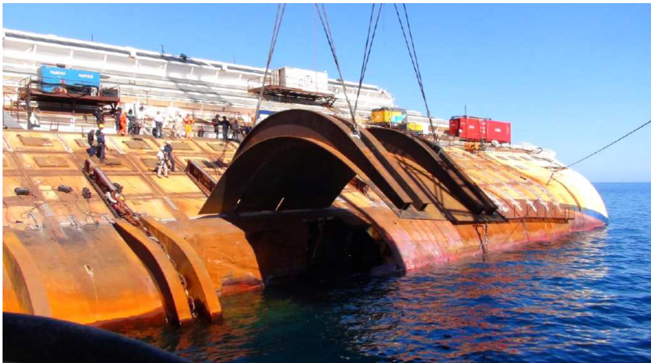
Sopra: Operazioni di installazione terza gash plate Sotto: Piattaforma 2
