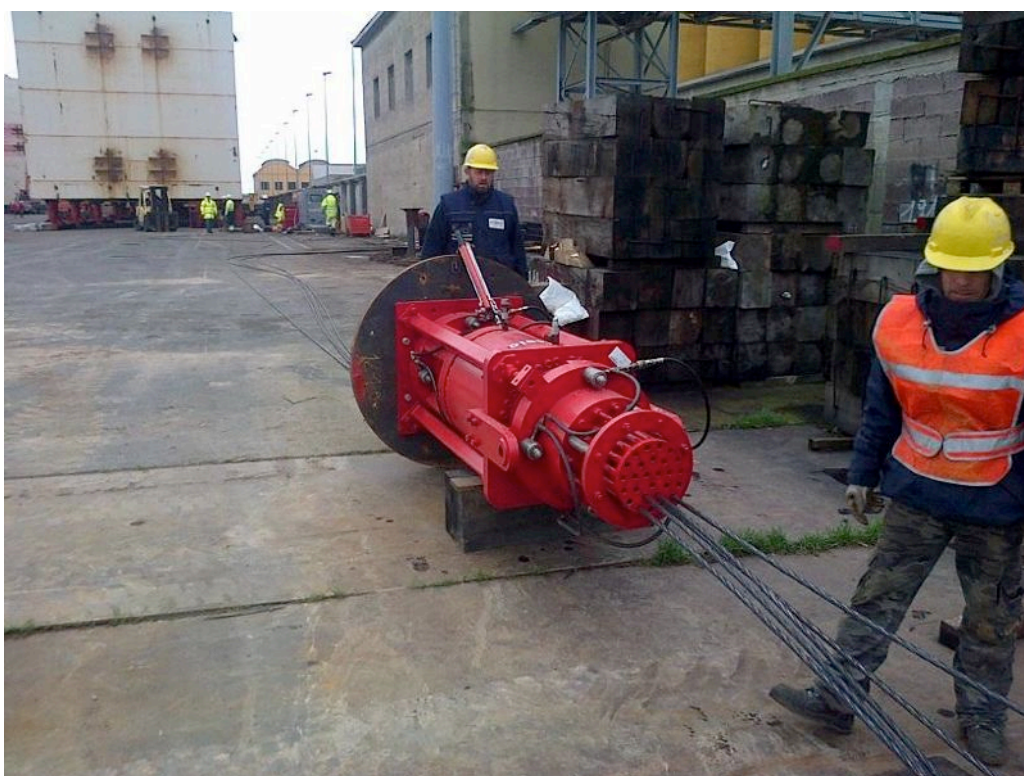
Installazione valvole da 12" sul cassone S12 nel cantiere di Livorno Assemblaggio dei martinetti nel cantiere di Livorno
