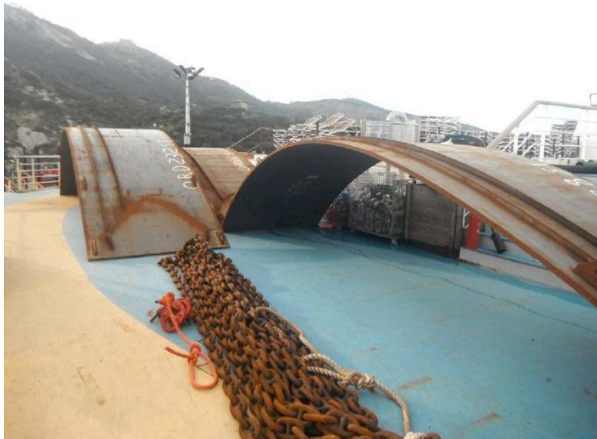
Rinforzi del ginocchio (Bilge Plates) da installare sul lato destro della nave per il passaggio delle catene Fabbricazione delle strutture respingenti (bumpers) sulla Costa Concordia
