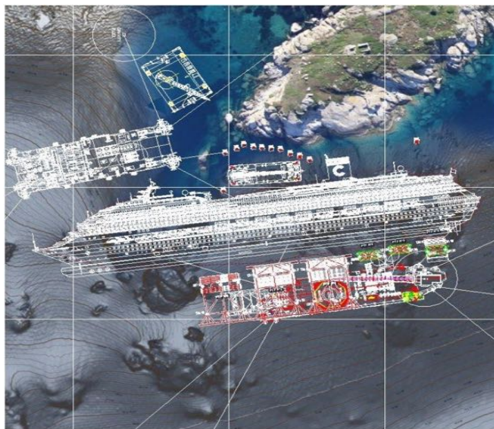
Figura 2.1. Il relitto della Concordia, i mezzi navali impiegati per la sua rimozione e le piattaforme per la rotazione nel tratto di mare di Punta della Gabbianara
