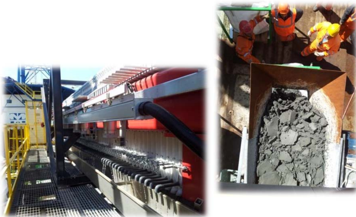
Filtropressa in azione (a sinistra) e il sedimento compattato e disidratato risultante (a destra)
